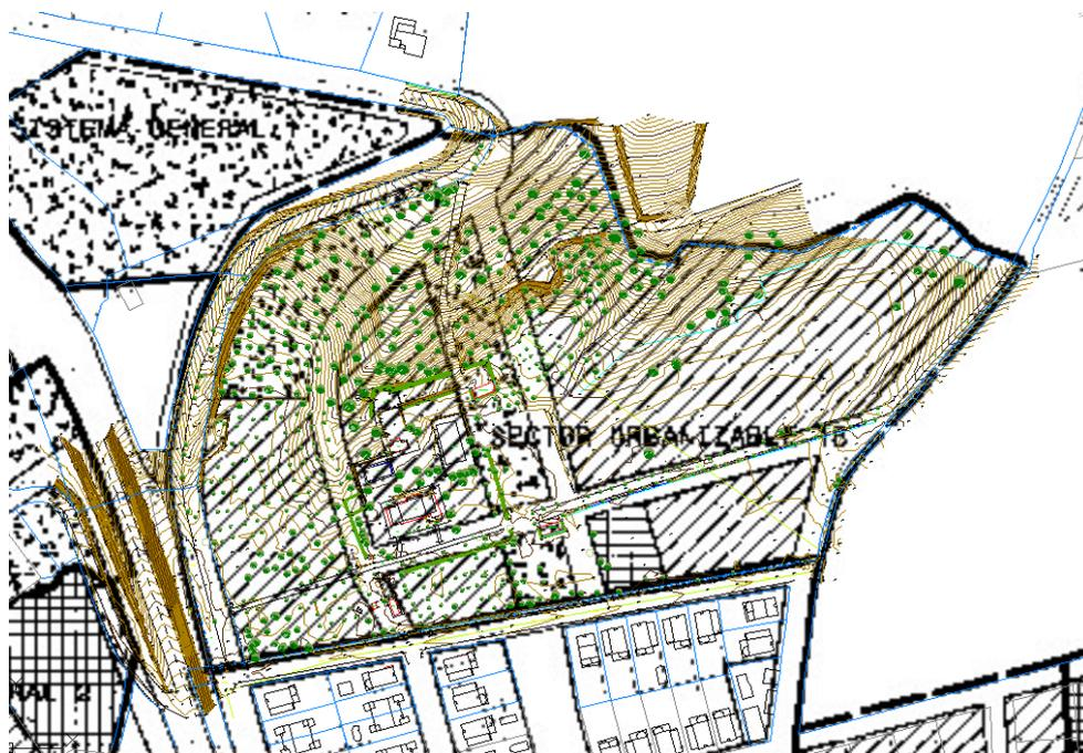
3. Superposición de la ordenación prevista en el PGOU y el levantamiento topográfico
